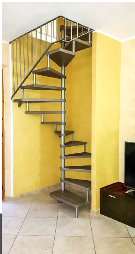
Scala a CHIOCCIOLA a pianta circolare composta da distanziali cilindrici in ACCIAIO INOX SATINATO , gradini in legno FAGGIO verniciati color mogano e ringhiera di protezione mista ACCIAIO INOX .
